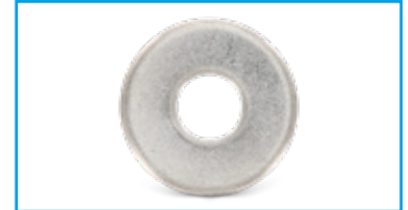
Rondela dış çapı ≈ 3 x Vida dişi çapı
