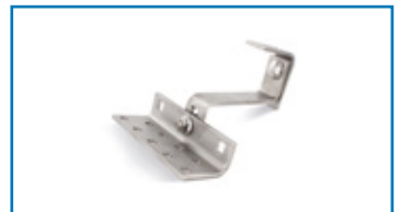
Vario-krok solfångare,inställbar 3 lägen, stål 5 mm, 140X56X5/5
