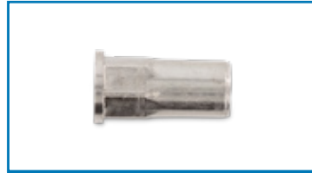
Nitmuttrar plant huvud, part. sexkantskaft slutna
