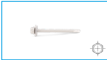
Boreskruer med sekskantet hoved og krave, form K, 16 mm tætningskive
