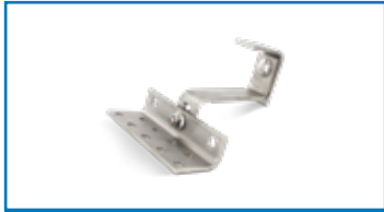
Vario-solkrog, 3 justeringsmuligheder, stål 6 mm, 140X56X5/6
